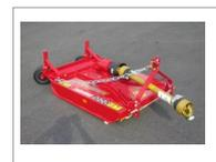
performance en terrains variés. Un volet arrière amovible et une bavette de protection avant en caoutchouc contribuent à la sécurité et à la protection de l'équipement. La hauteur de coupe est réglable de 4 à 16 cm à l'aide de patins et de sur-patins d'usure, et chaque modèle est équipé de trois panneaux de signalisation pour une visibilité accrue.
