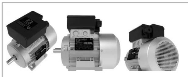
Moteurs électriques monophasé à induction conçu avec une isolation de classe F (température admissible du bobinage jusqu'à 155°C) et une protection IP55.
