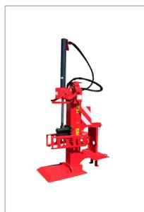
Le fendeur de bûches de 16 tonnes avec un dégagement de 125 cm de la marque Formule Directe est conçu pour des travaux de fendage intensifs, capable de traiter des bûches plus longues et de plus gros diamètre. Voici les recommandations pour son entretien afin d'assurer des performances optimales :
