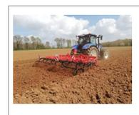
En fonction de la finition recherchée, le nombre de rangées de dents de la machine va varier. Des éléments travaillants équipés de 4 rangées de dents sont adaptés pour une finition plus grossière et moins sensible à la présence de quelques résidus, idéal pour les terres à maïs. Un Tetra avec 5 rangées de dents, fera une finition très fine, sans présence de résidus en surface, pour une terre à betterave par exemple.
