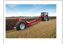
automatique de la ligne de traction, "Auto-line", pour un labour parfait. Le système Non-Stop mécanique travaille en décompression afin de préserver la vie de la charrue et du tracteur. Les corps se déclenchent indépendamment les uns des autres pour un labour optimal même en conditions pierreuses. Les poutres traités thermiquement garantissent la durabilité de la charrue. Une large gamme de versoirs et d'accessoires est disponible pour s'adapter à toutes les conditions de sol.
